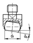
d1 = 50 d2 = M20 d3 = 34.5 d4 = 40 l1 +/-0.1 = 35 l2 = 20 Max static load (KN) = 165
